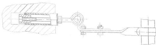
*Схема крепления лесов к стене*
